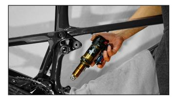
25. Install the lower shock bolt.
